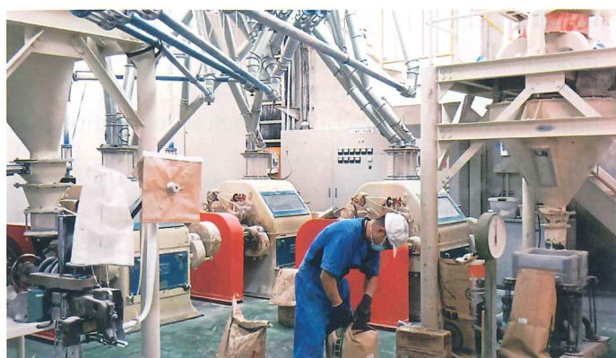
製造部門の強化を狙い、工場に導入したそば製粉プラントシステム。大量生産が可能になった＝松江市西忌部町、永江製粉工場
